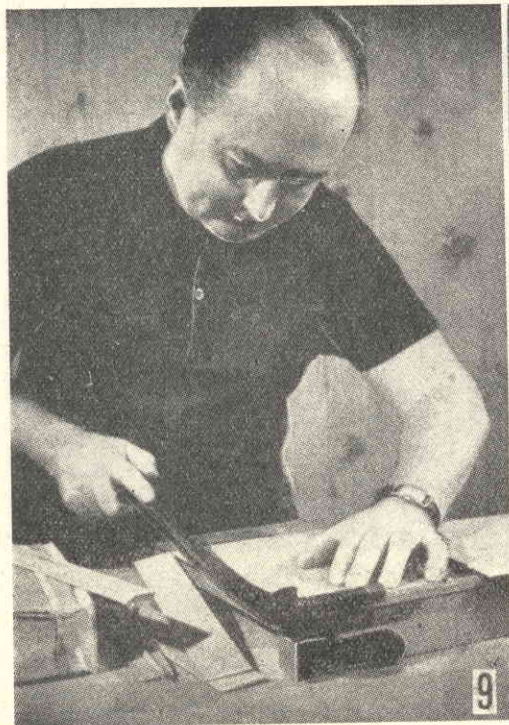
FIGURA 9 - Preparare, nelle giuste dimensioni, i due rettangoli di cartone per le copertine. Questo lavoro si fa alla perfezione con una trancia, ma può anche essere eseguito con un coltello affilato, o con una lametta. I rettangoli di cartone dovranno essere 10 mm. più lunghi e 3 mm. più larghi del formato dei fascicoli di "Fare".
