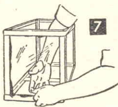
7 SISTEMAZIONE DI UN PANNELLO DI VETRO
