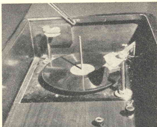
Come si vede, il cambiadischi viene installato in un radiofonografo, in luogo del normale complesso giradischi.
