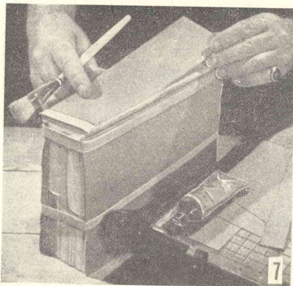
FIGURA 7 - Incollare una striscia di carta pesante, colorata, delle dimensioni della costola, al di sopra della garza. La lunghezza della carta dovrà essere tale che non abbia a coprire le due striscette di cimossa. FIGURA 8 - Montare un poco di cartavetro su di un blocchetto di legno mezzorotondo, e con questo lavorare sulla parte delle pagine opposte a quella della costola, per conferire all'insieme di esse una certa concavità. Per ottenere ciò, necessita, naturalmente, agire principalmente sulla parte centrale del gruppo delle pagine.
